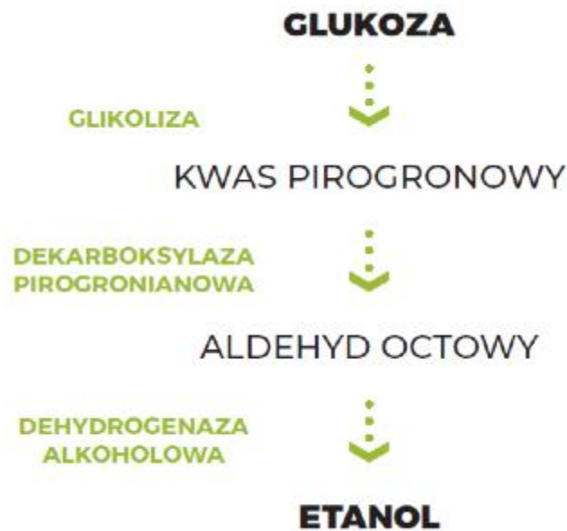
Rysunek 2 Konwersja glukozy do etanolu (za: Rębas JA, Drożdże i ich metabolity w procesie fermentacji alkoholowej, Przemysł Fermentacyjny i Owocowo-Warzywny 3/2021)
