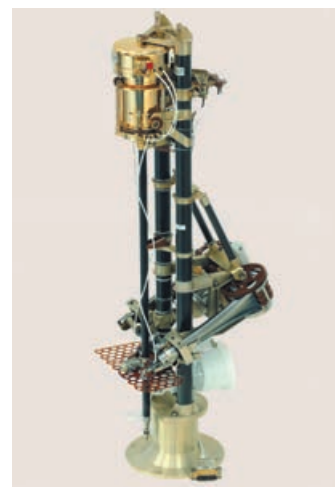
Rysunek 4 Przykład wykorzystania dwóch technologii rozwijanych w CBK PAN - penetrator w misji ROSETTA, elektromechaniczny element wbijający penetratora widoczny na górze, częściowo rozwinięty wysięgnik penetratora widoczny poniżej z prawej strony.
