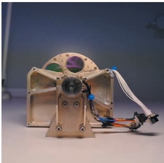
Rysunek 9 Model kwalifikacyjny układu służącego do zmiany filtrów optycznych w zestawie instrumentów naukowych koronografu słonecznego w misji PROBA-3
