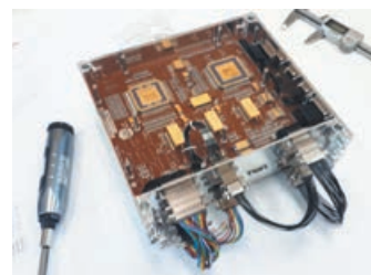
Rysunek 11 Blok komputera sterującego instrumentami naukowymi w misji PROBA-3
