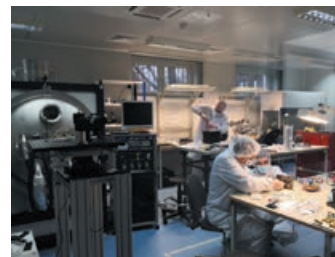
Rysunek 2 Prace w pomieszczeniu "clean-room" w CBK PAN. Z lewej widoczna mała komora TVAC
