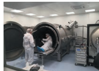
Rysunek 3 Montaż instrumentu GLOWS w dużej komorze TVAC w CBK PAN
