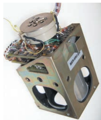
Rysunek 8 Model kwalifikacyjny skanera IR dostarczonego przez CBK PAN dla misji BeppiColombo
