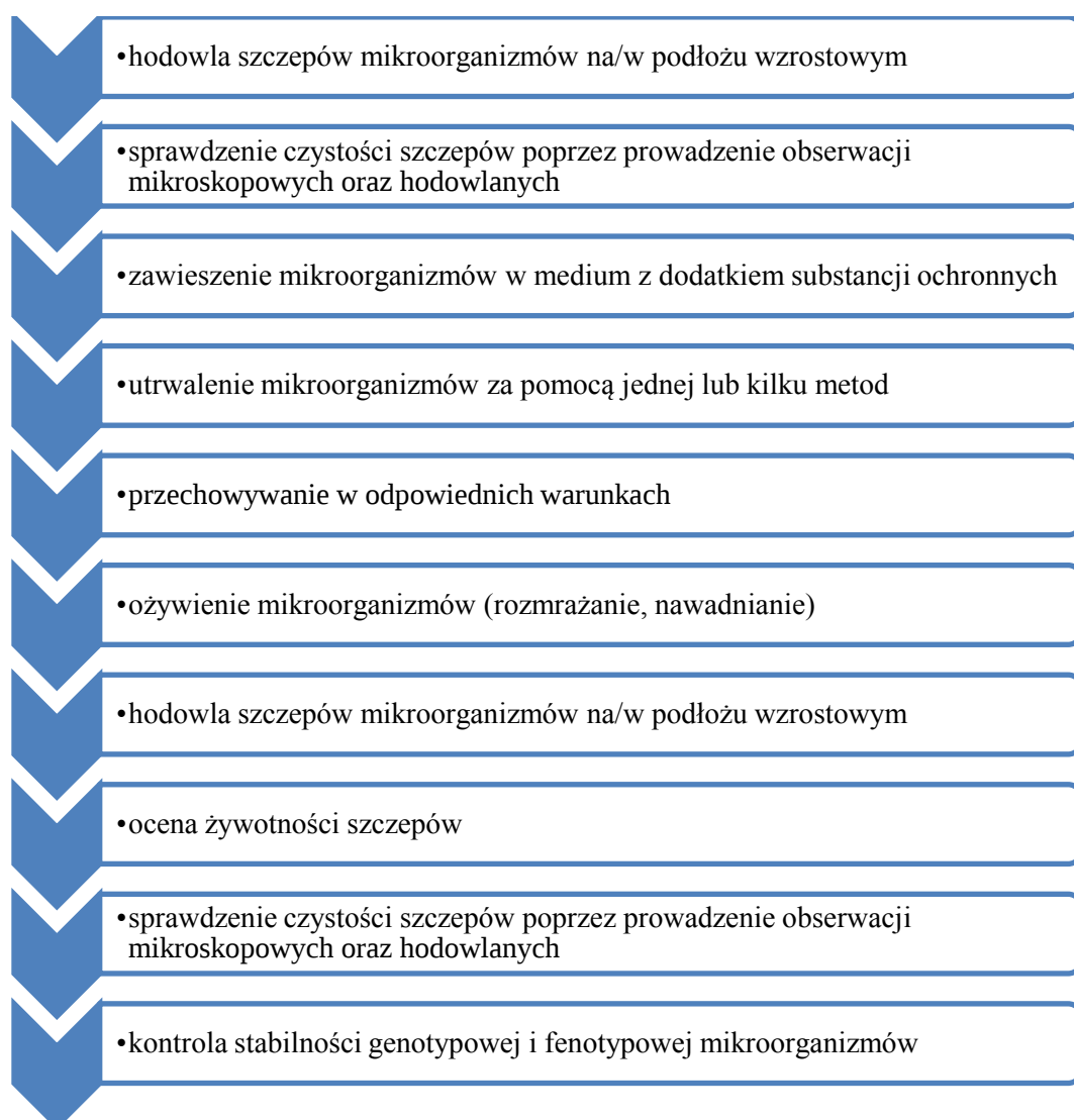
Rysunek 1 Schemat postępowania z mikroorganizmami w kolekcjach kultur (za: Akimowicz M, Sokołowska B, Zamrażanie i liofilizacja jako techniki utrwalania i przechowywania mikroorganizmów, ŻYWNOSĆ. Nauka. Technologia. Jakość , 2021, 28, 1 (126), 28 – 38)
